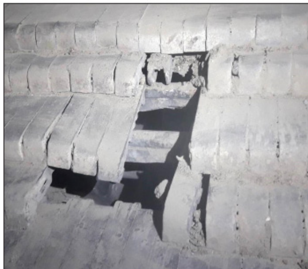
Une grille d'un four d'une UVE endommagée par l'explosion d'une ou de plusieurs bouteilles de protoxyde d'azote.
